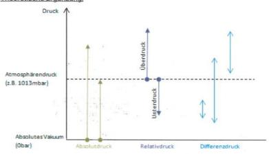
Als\_Absolutdruck wird jener Druck bezeichnet, der ausgehend vom absoluten Vakuum (0bar) vorherrscht. Auf Meereshöhe ist der Absolutdruck gleich dem Atmosphärendruck von 1013mbar.
